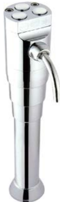
1355 Schanksäule "Xenia" – verchromte Messingschanksäule für Soda- und Premix-Getränke – 3-leitig, wählbar über Druckknöpfe im Deckel – 3 integrierte Schlauchleitungen 7 mm – Befestigung mit Gewindestutzen 3/4" – Höhe (gesamt): 320 mm
